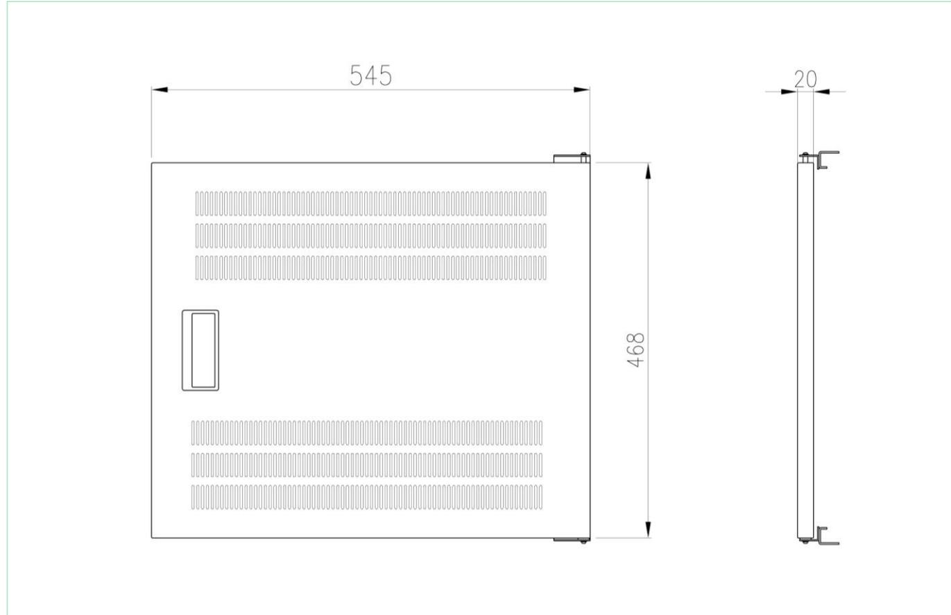
■Z-Master7000シリーズに適する放熱対策も考慮したパネル。ラッチ採用により工具無しで容易に取り外しが可能です。
