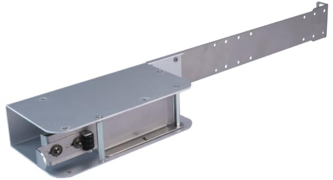
RXT 1001 は、電源アダプタ(RPS A100)ホルダー部とマウントブラケット金具で構成されています。ラックフレーム RFR 1000-1 のマウントブラケット金具を取り外し RXT 1001 に付け替えることにより、電源アダプタ(RPS A100)をラックフレームの後側に確実に固定することが出来ます。
